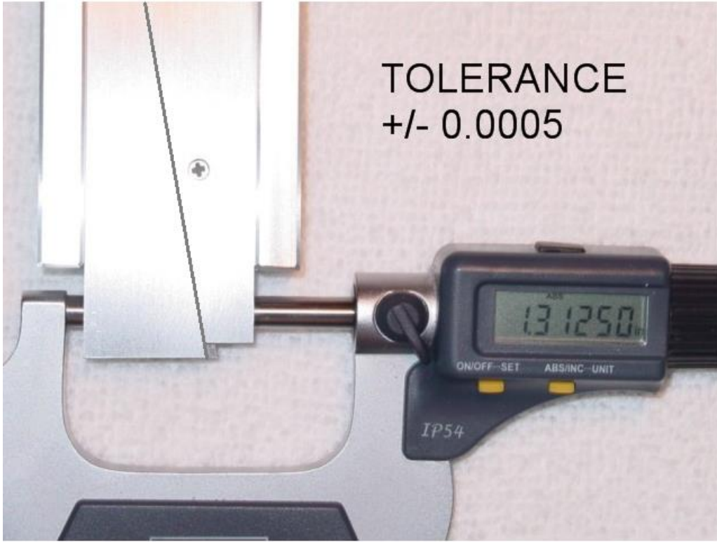
شكل رقم ١٩٤: قياس المسافة الخارجية لمحدد التوازي بجهاز ميكرومتر دقة ٠,٠٠٠٥
