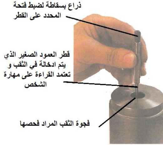
شكل رقم ١٩٩: إدخال محدد الثقوب داخل التجويف
