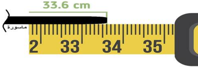
شكل رقم ٢٤: قياس طول الماسورة ٣٣,٦ سم
