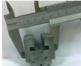
شكل رقم ٥٧: خطأ ميل القدمة عند إجراء عملية القياس
