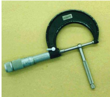
شكل رقم ١٧٢: قياس القطر باستخدام ميكرومتر
