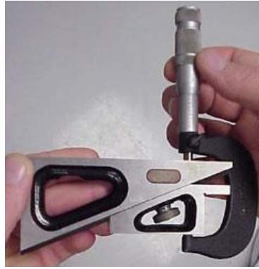
شكل رقم ١٩٦: ضبط البعد المطلوب باستخدام ميكرومتر
