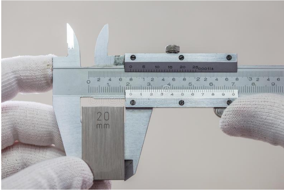
شكل رقم ١٥٨: وضع قالب قياس بين فكي القدمة ذات الوراثة
