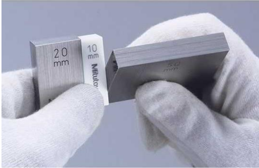
شكل رقم ١٥٦: طريقة تجميع قالبين
