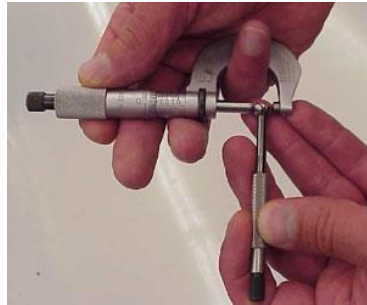
شكل رقم ٢٠٠: قياس البعد المقاس بطرفي محدد الثقوب
