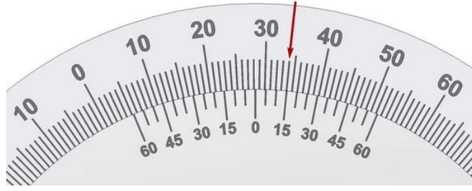
شكل رقم ١٢٥: تدريج الورائبة (القراءة المسجلة ١١٥ ٥٢٨)
