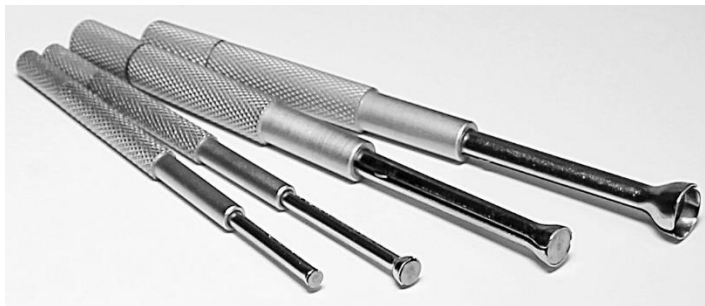
شكل رقم ١٩٨: محددات الثقوب وتحديد قيمة القطر عن طريق الميكرومتر
