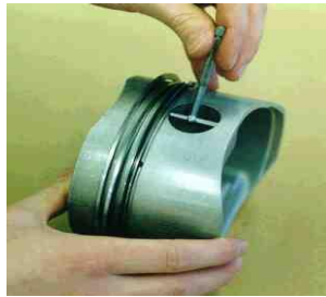
شكل رقم ١٧١: وضع محدّد الثقب بشكل متعامد داخل الثقب
