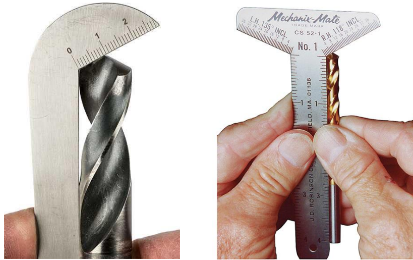
شكل رقم ١٨٢: قياس طول الحد القاطع و زاوية الرأس
