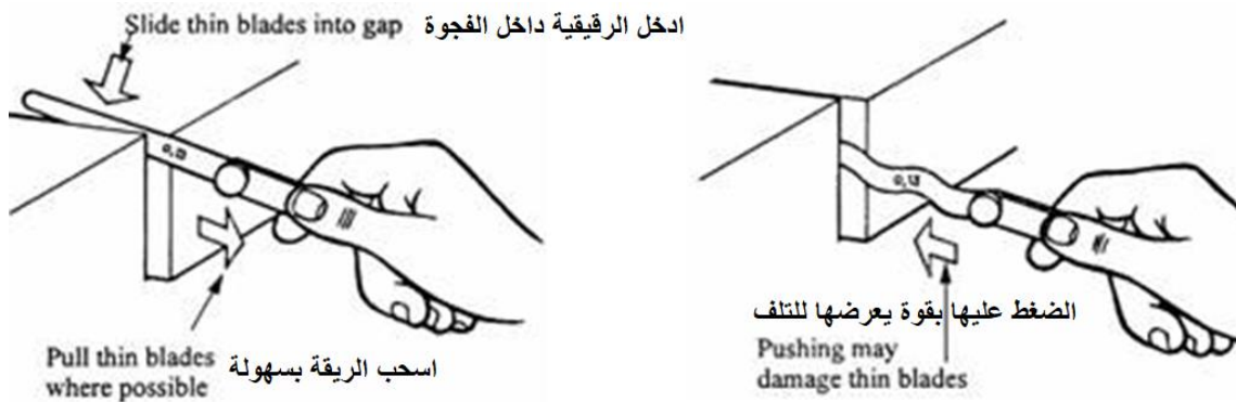
شكل رقم ١٨٨: الاستعمال الصحيح لل-filler
