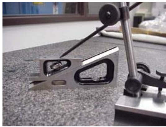
شكل رقم ١٩٧: ضبط ارتفاع شوكة العلام
